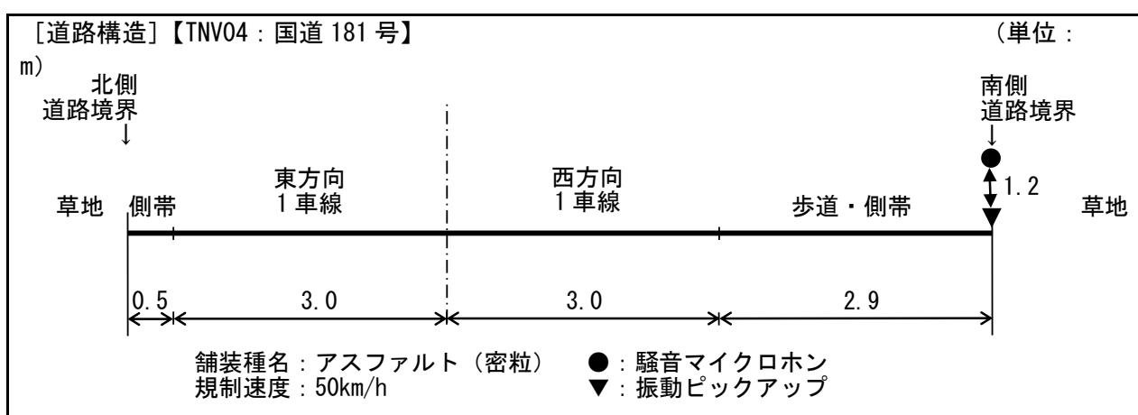
図 12.1.1-13 道路交通騒音・振動調査地点の道路断面構造
