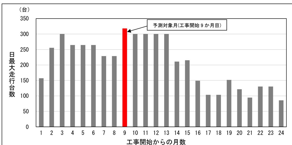
図 12.1.1-14 工事関係車両の月別交通量（小型車換算）
