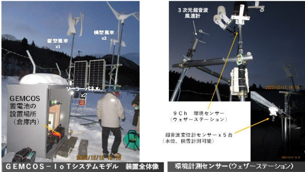
図 4. 鱒ヶ沢町立アユ養殖場で実施した、GEMCOS-IoT システム装置、遠隔的な環境計測(ウェザーステーション)と機器制御用 GEMCOS 蓄電池、人工養殖モデル実証試験の風景。
