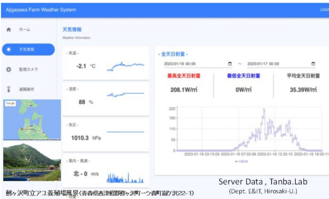
図 5. 青森県西津軽郡鱒ヶ沢町立アユ養殖場で、GE-MCOS-IoT システムと LoRaWAN ネットワークを使って、環境データ(天候、気象、積雪深さ)を常に観察できるクラウド上のデータ事例。
