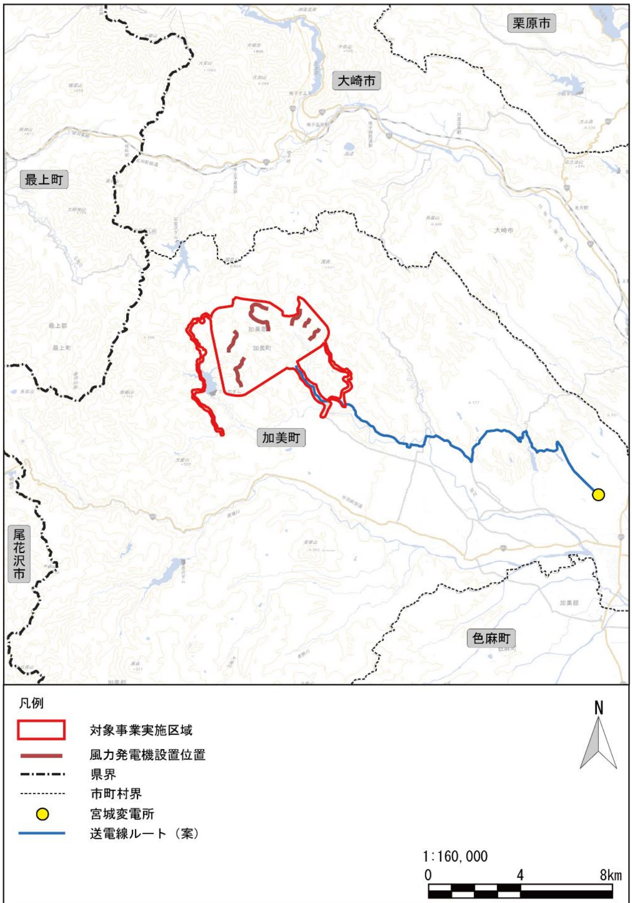
第2.2-6図 変電所の位置及び送電線ルート（案）
